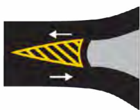
MARCAS CANALIZADORAS DE TRÁNSITO E ISLETAS PARA CIRCULACIÓN BIDIRECCIONAL (No se puede circular sobre ellas)
