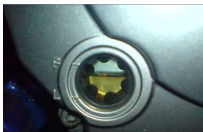
Revisión mediante visor del tipo "ojo de buey"
