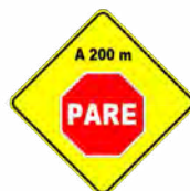
PROXIMIDAD DE SEÑAL RESTRICTIVA (Pare)
