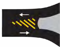
MARCAS CANALIZADORAS DE TRÁNSITO E ISLETAS PARA CIRCULACIÓN BIDIRECCIONAL (No se puede circular sobre ellas)
